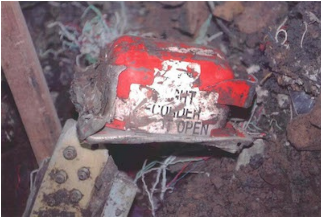
Figura 9. Le due “scatole nere” del volo UA93. Il Flight Data Recorder fu ritrovato a quattro metri e mezzo di profondità, mentre il Cockpit Voice Recorder a più di sette metri. Immagini tratte dagli atti del Processo Moussaoui.
