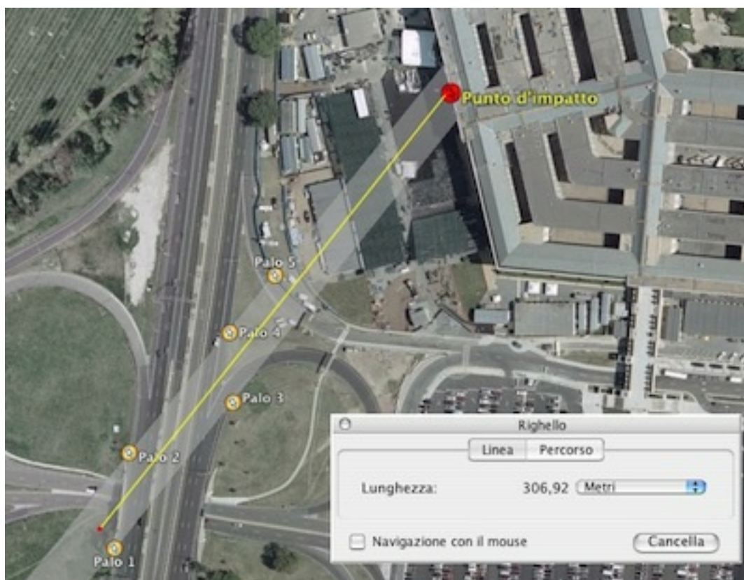
Figura 27. La traiettoria dell'aereo, ricostruita sulla base dei lampioni abbattuti, indica un volo radente almeno negli ultimi 310
